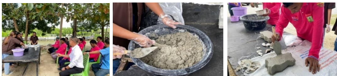
ภาพที่ 4 สาธิตวิธีการและการขึ้นรูปอิฐบล็อก แล้วนำไปตากแดด
