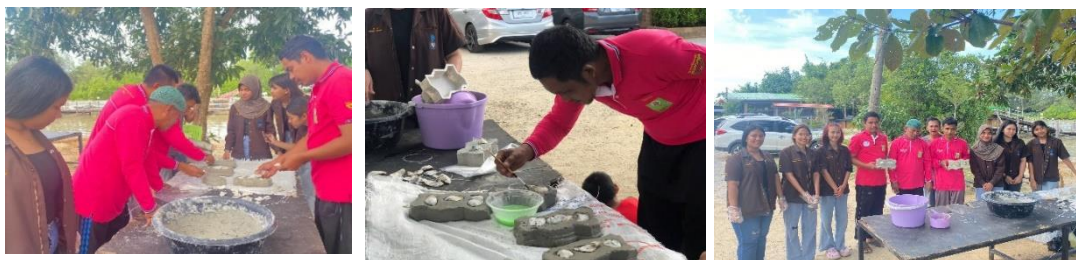
ภาพที่ 5 การตกแต่งอิฐบล็อกและผสมสารที่ทำให้เรืองแสงแล้วนำไปทาที่หน้าอิฐบล็อก
