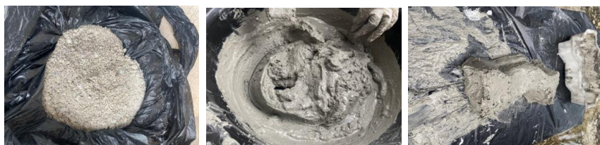
ภาพที่ 1 การทดลองครั้งที่ 1 เนื้อปูนมีความเหลวมากเกินไปจนไม่สามารถขึ้นรูปได้
