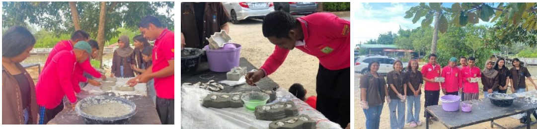
ภาพที่ 5 การตกแต่งอิฐบล็อกและผสมสารที่ทำให้เรืองแสงแล้วนำไปทาทับหน้าอิฐบล็อก ที่มา :อนุตตรีย์ มะเดื่อ, วันที่ 16 มกราคม 2567
