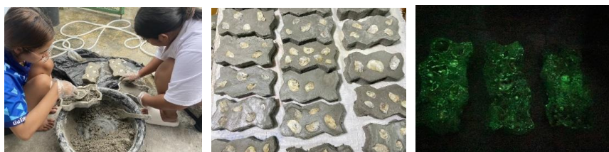
ภาพที่ 2 เนื้อปูนมีความสมดุลสามารถขึ้นรูปได้ เป็นการทดลองที่ประสบความสำเร็จ
