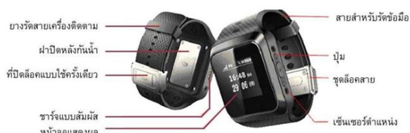
ภาพที่ 1 ส่วนประกอบของอุปกรณ์อิเล็กทรอนิกส์ติดตามตัวยี่ห้อ Xentrack รุ่น NS-EM1
