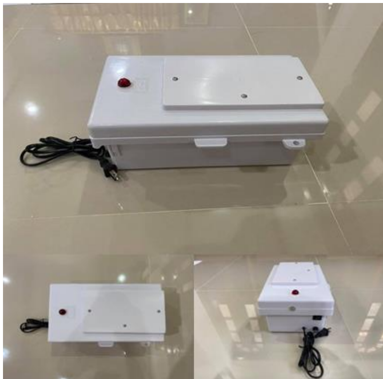
ภาพ 11 เครื่องฆ่าเชื้อโรคด้วยแสงยูวีแบบเคลื่อนที่ต้นแบบ
